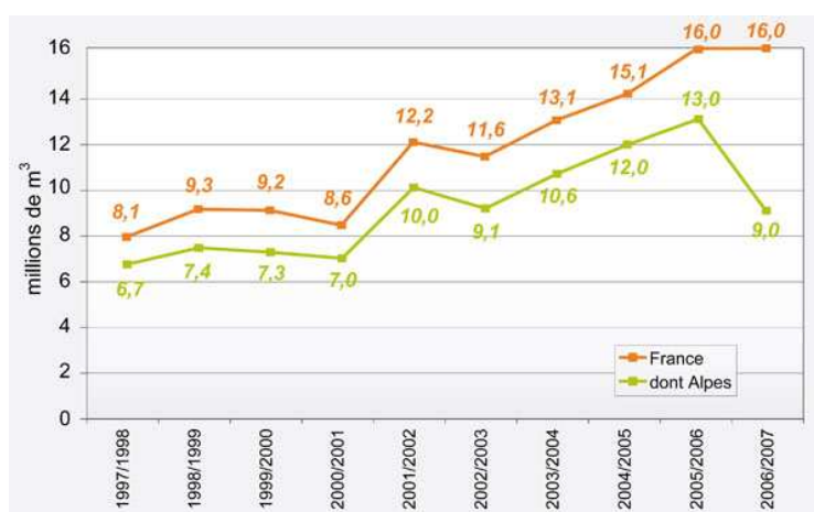
Consommation annuelle d'eau des installations de neige de culture
