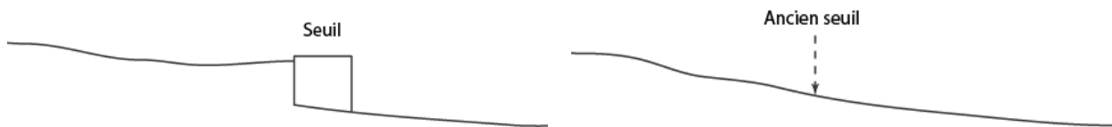
Schéma vu en coupe du profil en long de la rivière avant et après arasement d'un seuil
