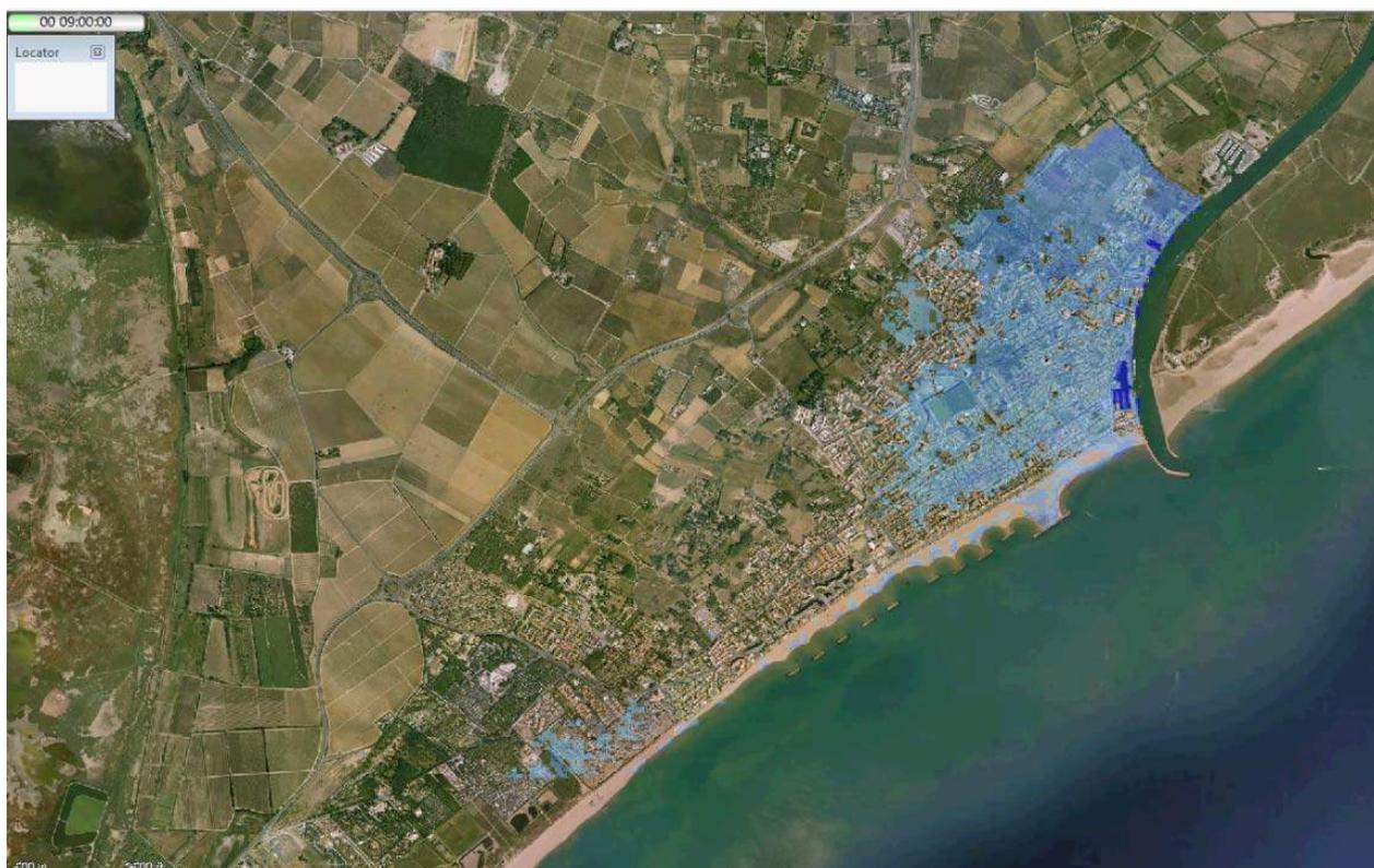
**Figure 132 : Hauteurs maximales à T+18 h (Brèche 2)**
