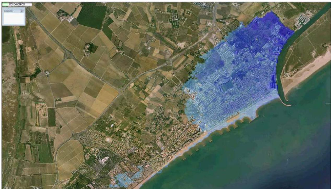
**Figure 116 : Hauteurs maximales à T+5 h (brèche 1)**
