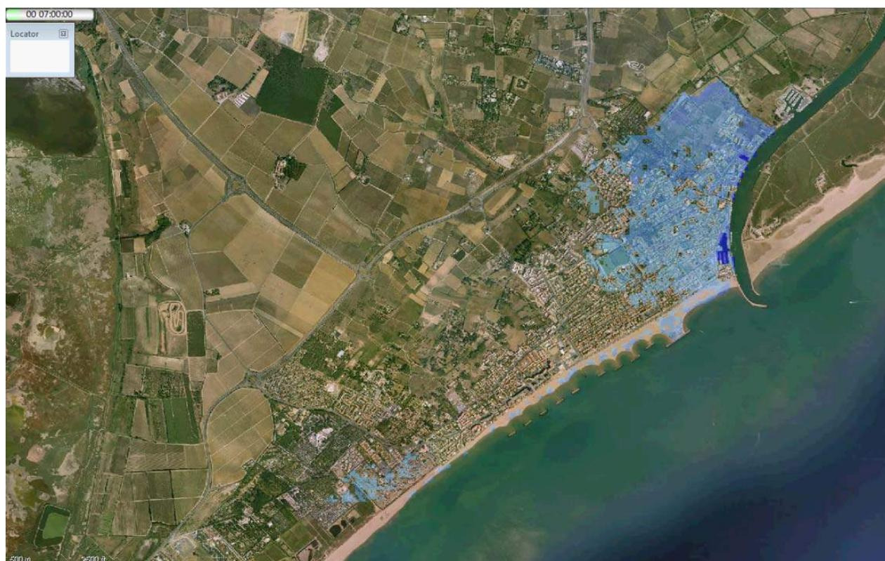
**Figure 130 : Hauteurs maximales à T+8 h (Brèche 2)**
