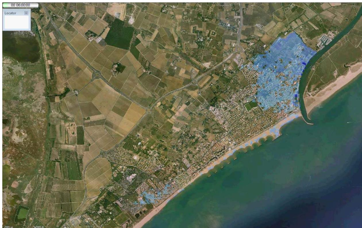
**Figure 129 : Hauteurs maximales à T+7 h (Brèche 2)**
