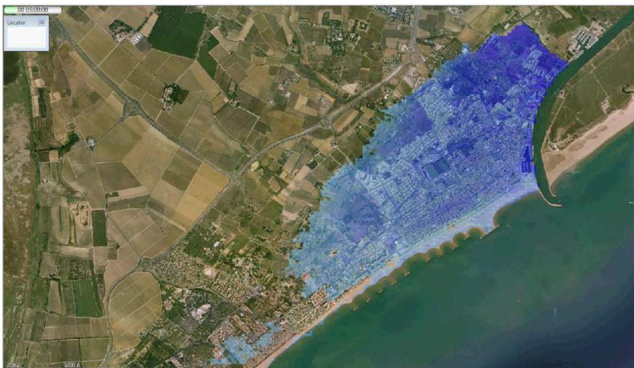
**Figure 91 : Hauteurs maximales à T + 6 h**
