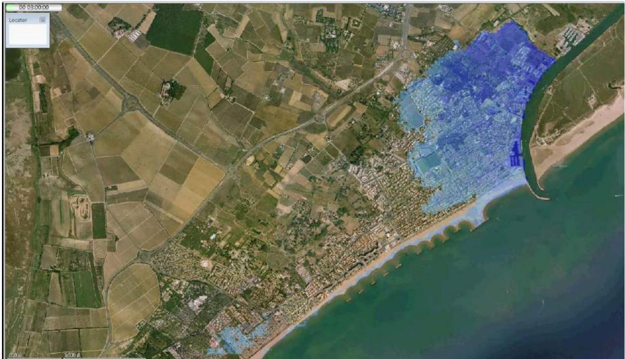
**Figure 115 : Hauteurs maximales à T+4 h (brèche 1)**
