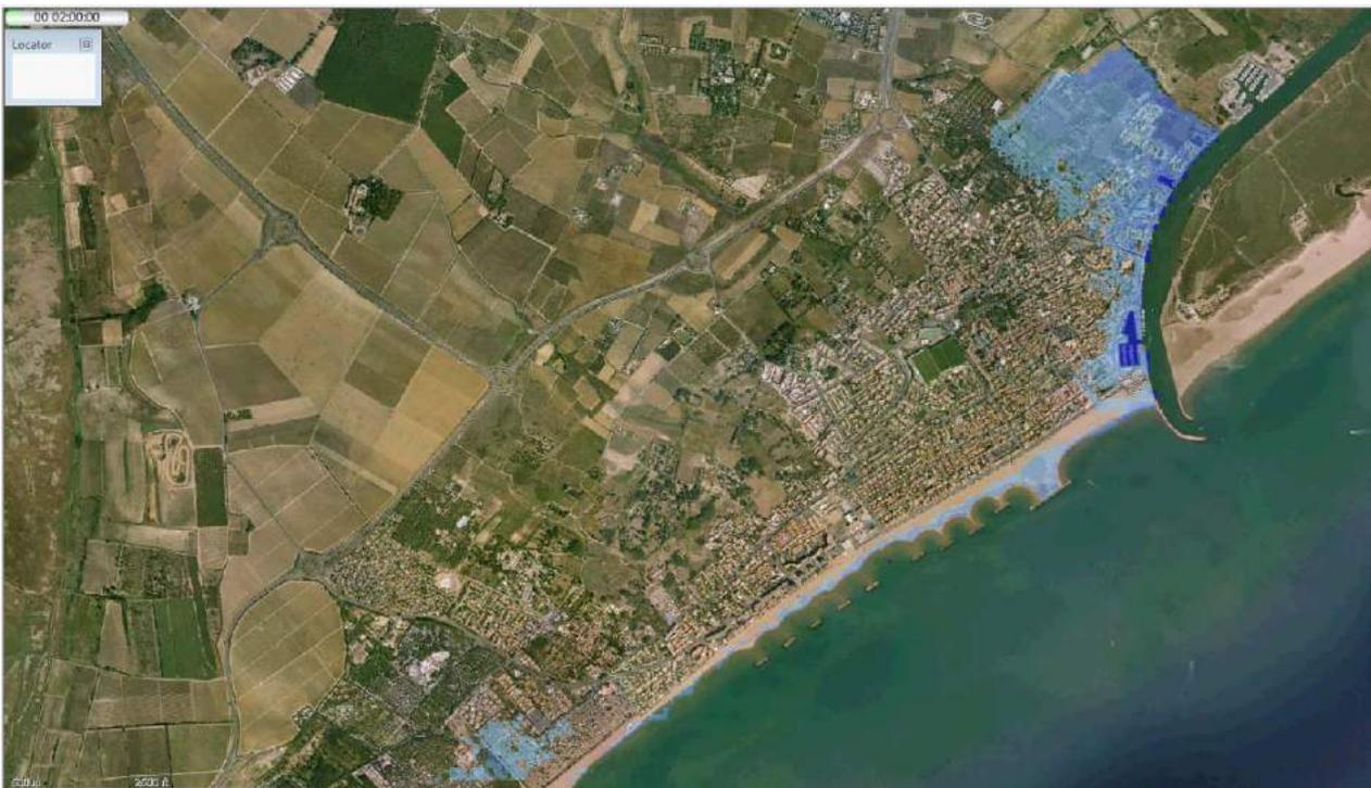
**Figure 114 : Hauteurs maximales à T+3 h (brèche 1)**
