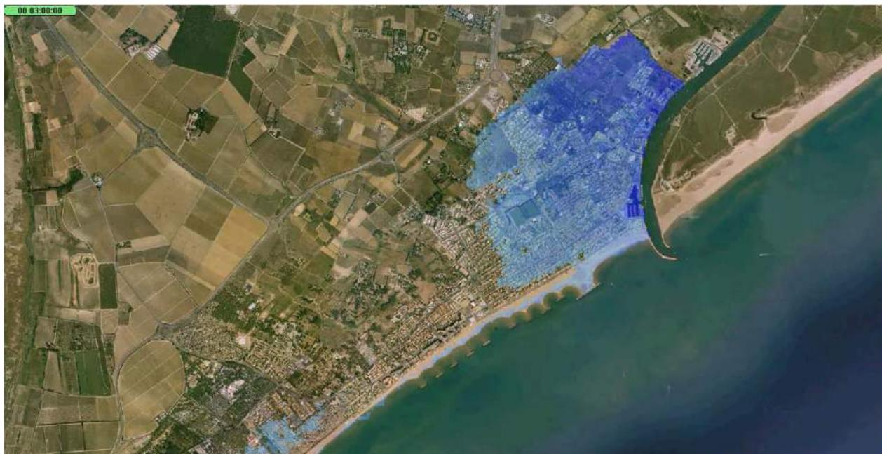
**Figure 102 : Hauteurs maximales à T + 4 h**
