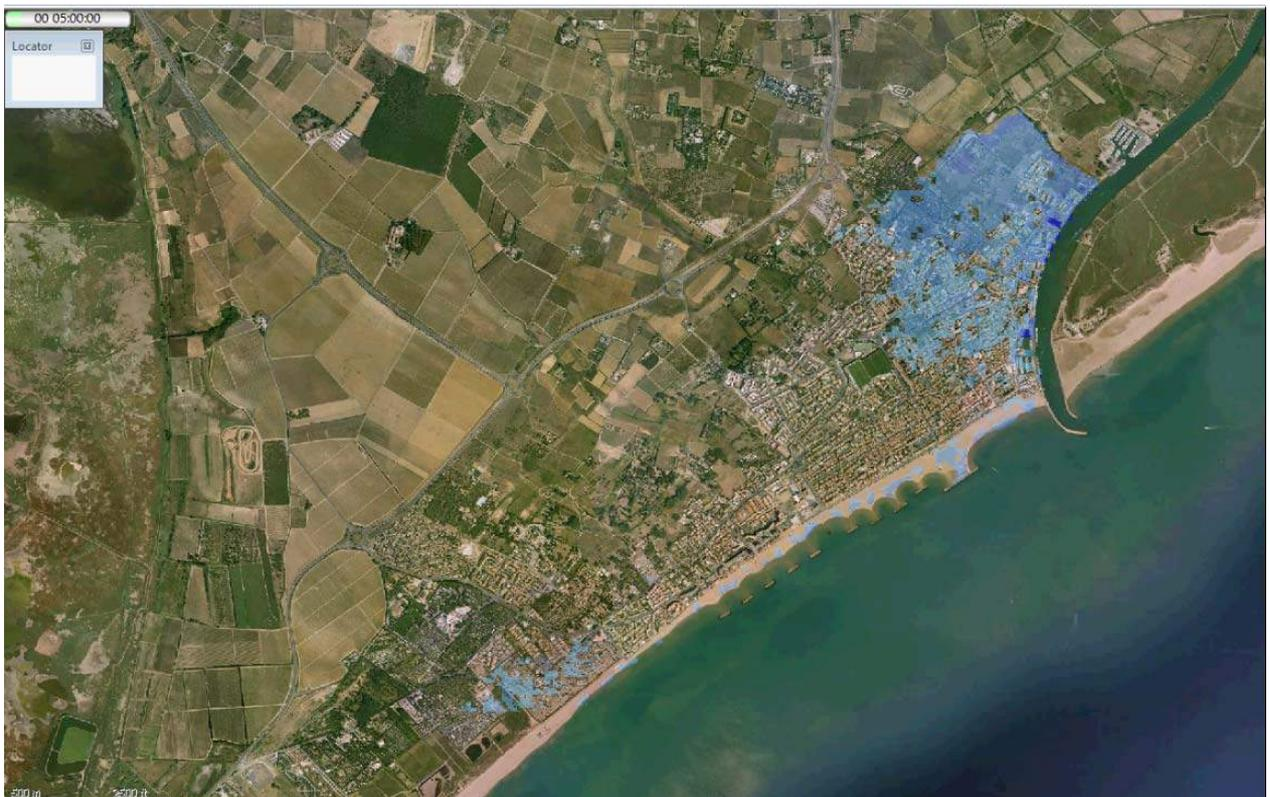
**Figure 128 : Hauteurs maximales à T+ 6 h (Brèche 2)**
