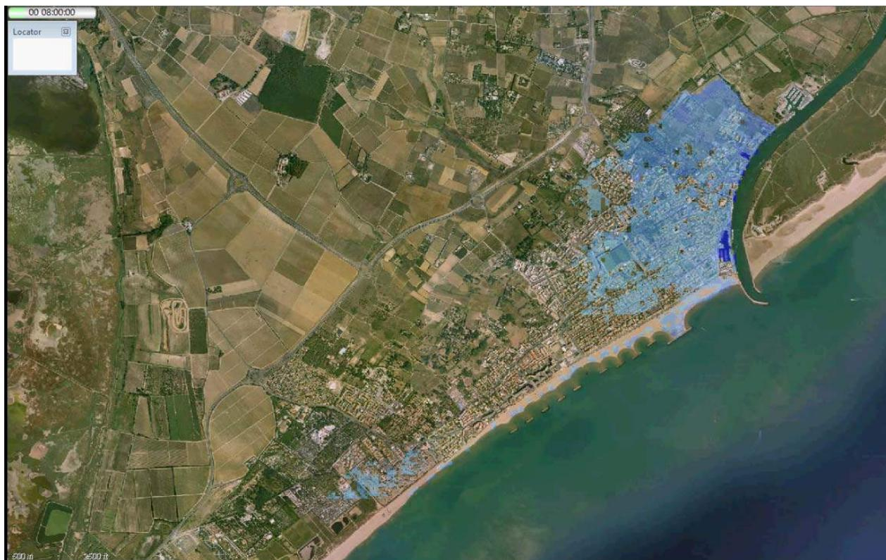
**Figure 131 : Hauteurs maximales à T+9 h (Brèche 2)**
