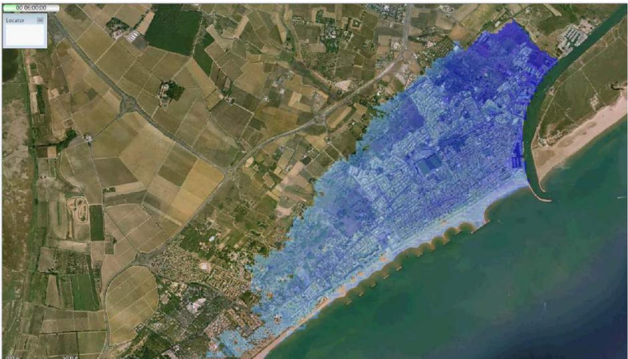
**Figure 118 : Hauteurs maximales à T+7 h (brèche 1)**
